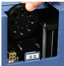
图片 2-2. 将 Multiskan FC 滤光片转轮放入滤光片槽中
